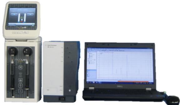
注)シリンジポンプとマイクロGCの接続イメージ写真
