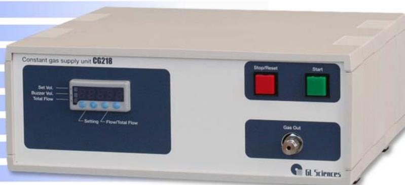
サンプリングバッグ内に一定量のガス(清浄空気もしくは窒素)を正確に計量、供給することができる装置です。設定量のガスを供給後、電磁弁で自動停止するため、作業の省力化が可能になります。
