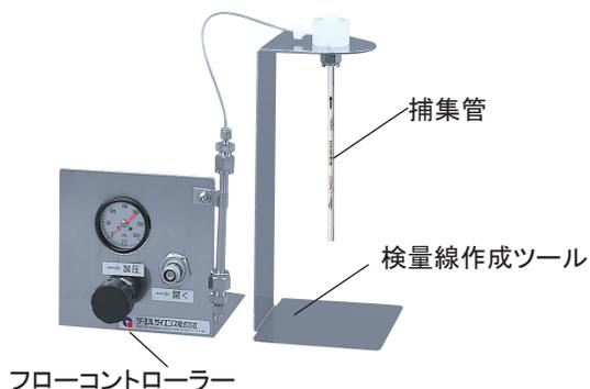
サンプルチューブに標準溶液や標準ガスを直接注入するツールです。配管をフローコントローラーに接続し、不活性ガスを流しながら、マイクロシリンジで検量線作成ツールに接続した捕集管に標準溶液や標準ガスを添加できます。
