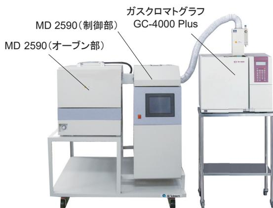
オンラインシステムは、サンプルのセットから分析部への導入までを自動で行うため、外気や人為的影響を受け難く、測定に不慣れな方でも簡単に精度の良い測定が可能です。ガスが通るラインは、保温されています。チャンバーの大きさにあわせてMD 2570、MD 2590より選択できます。
