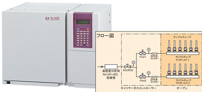
最大12本のサンプルチューブを取り付けでき、最良なコンディショニングを実現します。
