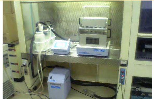
ケルダール分解装置と酸ミスト・トラップ装置
