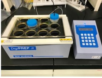
メスシリンダーと同等精度のメモリを持つ万能PPチューブを用いてサンプルの溶解、抽出等の様々な処理が可能です。使い捨てチューブなので容器の洗浄も不要です。
