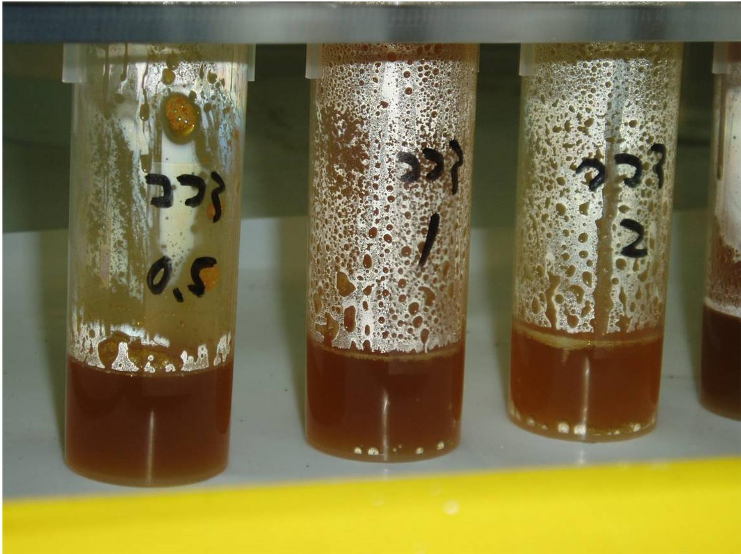
硝酸処理後、過酸化水素で処理
