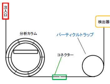
パーティクルトラップは、プロットカラムから剥離した粒子をトラップし、検出器の汚染やスパイクノイズが現れることを防ぎます。TC-PLOT シリーズの全てのカラムは、粒子剥離を極力抑えています。また、圧力変動が起こるバルブスイッチングGC システムやMS 検出器に使用する際は、パーティクルトラップの使用をお勧めします。
